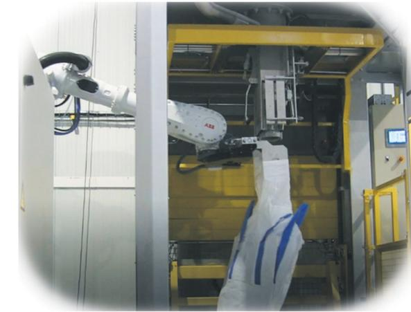
Cabezal de llenado, sujeción y sistema estanco
