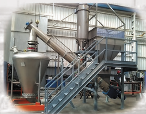
Instalación de descarga Big-bag con transporte neumático en fase densa
