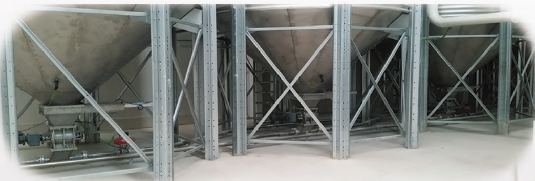
Instalación de transporte neumático en fase diluida por vacío.
