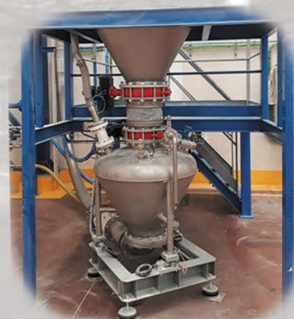
Propulsor neumático fase densa con sistema de pesaje
