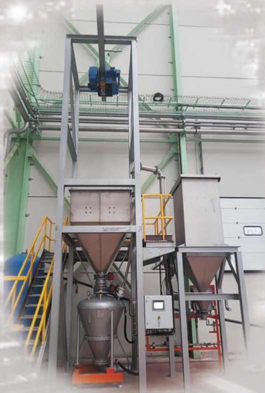
Instalación completa de descarga y transporste neumático en fase fluidificada hasta silos.
